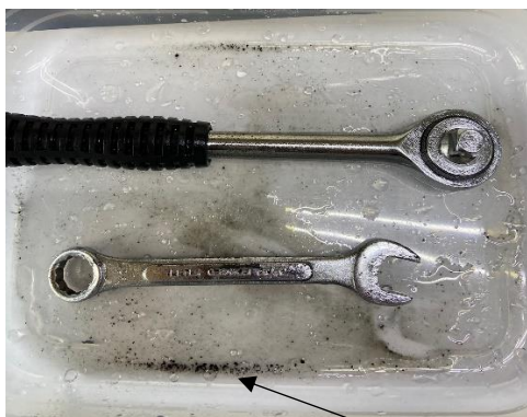
廃液後、赤錆は完全に溶解。(鉄粉)
