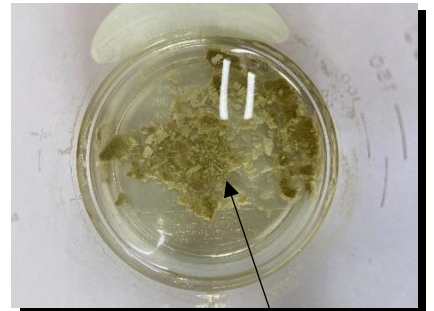
カルシウムは溶解し、シリカは剥離分解した画像 (2時間)
