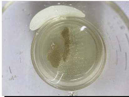
5倍希釈のゾロンSSSに、↑混合シリカスケールを浸漬した画像
